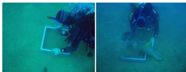
Fotografía 8. Detalle buceador tomando muestra de sedimentos y macrofauna bentónica, mediante cajón de toma de muestras.
